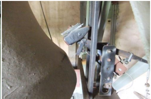
Läutewerk der großen Glocke, 1983 Hammer für Glockenanschlag (große Glocke)
